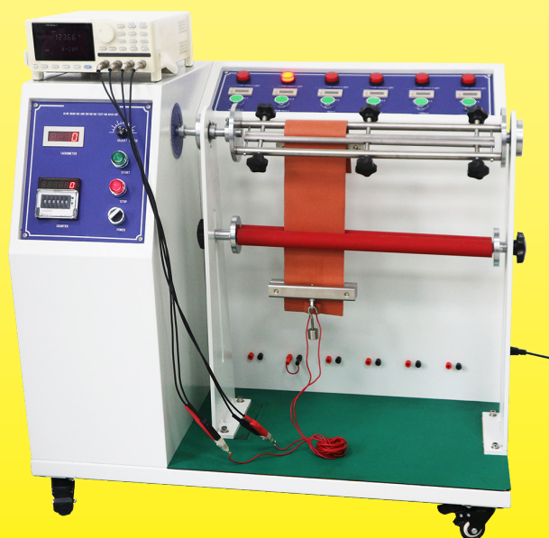
Résistance chauffante flexible en cours d'essai
